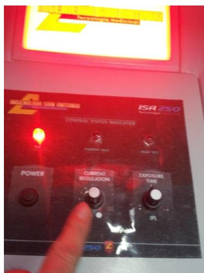
Dicha intensidad estará indicada por la perilla a tal fin, indicando con un led azul la potencia máxima, que se encuentra en la parte frontal del tablero de control.
