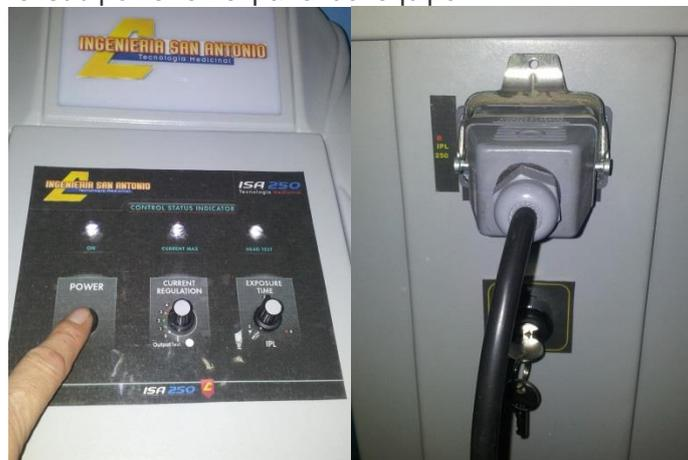
Con la maquina en funcionamiento, el siguiente paso es darle la intensidad de potencia adecuada al disparo, para lo cual debemos girar el dispositivo regulador en sentido horario con fin de incrementar la intensidad de potencia y en sentido contrario para reducirla.
